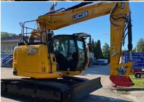
A483 LC Unterwagen mit Laufwerkslänge: 3.585 mm und Spurweite: 1.990 mm inkl. Planierschild, statische Abmessungen: Laufwerksbreite in Kombination mit Bodenplatten im Datenblatt beachten
